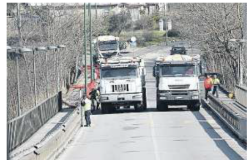
I TEST Le prove di carico effettuate sul ponte «Morandi»
